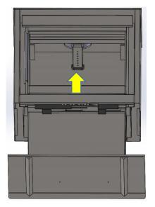
1. MAKE SURE TO INSTALL AIR TUBE AS REQUIRED. THE OPENING ON THE TUBE END NEEDS TO BE AGAINST THE BACK WALL. ALL ROUND EXIT HOLES MUST BE POINTING TO THE BOTTOM OF THE FIRE BOX OR THE SIDE WALLS.
