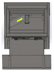
2. CERAMIC BAFFLE PLATES SIZE 230mmX240mm. INSTALL THE BAFFLE PLATE 230mm FRONT TO BACK, 240mm SIDE TO SIDE. GET BAFFLE PLATE INSIDE THE FIREBOX AND TILT ON AN ANGLE. PUSH BAFFLE PLATE OVER THE AIR TUBE
