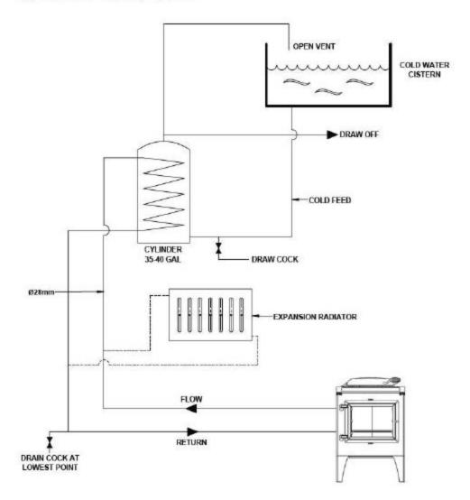
Figure 8 DHW Gravity Heating System
