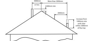
Figure 6 REFERENCE: AS2918:2018 FIGURE 4.9 - MINIMUM HIGHT OF FLUE SYSTEM
